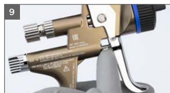
9 Sichtbarer Bereich der Luftkolbenstange einfetten
