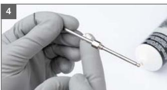
4 Farbnadel im Bereich der Nadeldichtung einfetten
