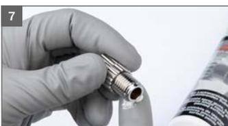
7 Gewinde der Materialmengenregulierschraube einfetten
