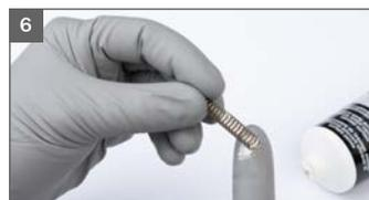
6 Farbnadelfeder einfetten und einsetzen
