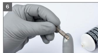
6 Farbnadelfeder einfetten und einsetzen
