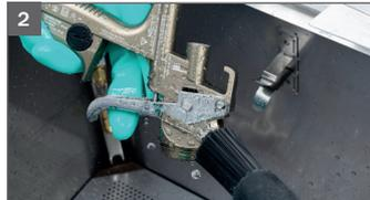
2 Reinigen des Pistolenkörpers
