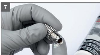
7 Gewinde der Materialmengenregulierschraube einfetten
