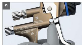
9 Sichtbarer Bereich der Luftkolbenstange einfetten
