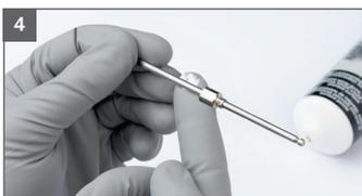
4 Farbnadel im Bereich der Nadeldichtung einfetten
