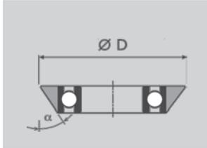
**Zubehör für Bündigfräser mit Kugellager unten**
