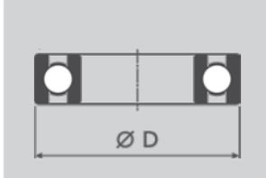
**Zubehör für Fasefräser HW mit Kugellager oben**
