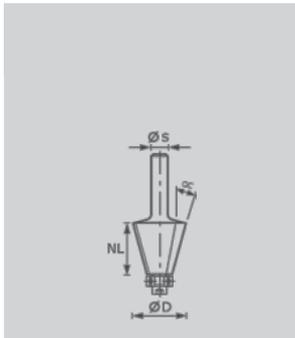
**Fasefräser HW mit Anlaufkugellager**
