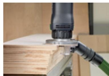
Fasefräsen von Kunststoff- oder Massivholz-umleimern.
