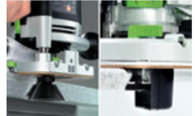
Mit dem Abrund-Fasefräser wird anschließend die Fase mit einem Radius verbunden. Das System ist ausgelegt auf 2 oder 3 aufgedoppelte Platten mit 12,7 mm Stärke.
