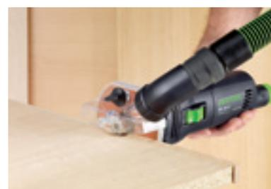
Bündigfräsen von Kunststoff- oder Massivholz-umleimern.
