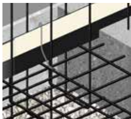
Befestigung an der Bewehrung mit Haltebügeln
