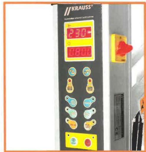
Über das Bedienfeld können **6 verschiedene Trocknungszeiten** eingestellt werden. Die Strahler sind einzeln zuschaltbar.
