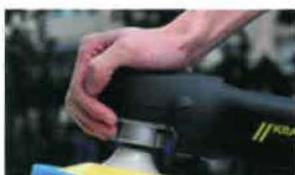
Die KRAUSS SUPERPOLISH P7 verfügt über einen äußerst flachen Getriebekopf, um den Abstand zur Oberfläche so gering wie möglich zu halten. Durch den niedrigen Schwerpunkt, ergibt sich eine deutlich spürbare Verbesserung im Handling des Polierers. Die Griffhaube ist ergonomisch geformt für optimale und präzise Führung.
