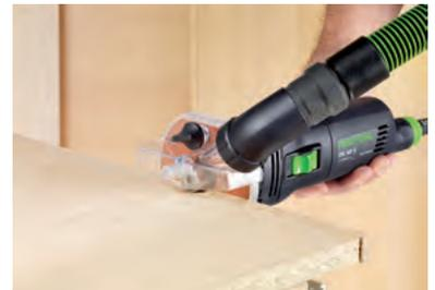
Bündigfräsen von Kunststoff- oder Massivholz-
