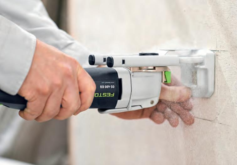
**Genau sägen am Anriss mit der Ansetzhilfe:**
