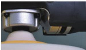
Eine verbesserte Luftführung sorgt für eine optimale Kühlung von Getriebe und Motor. Weiterhin ist der Motor mit einer elektronischen Drehzahlkonstanthaltung und Sanftanlauf ausgestattet.
