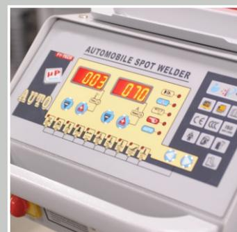
Inverter-Spotter mit 10 auswählbaren Schweißprogrammen und Einstellung der Schweißleistung- und Dauer.
