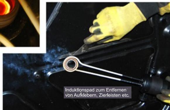
**Induktionspad zum Entfernen
