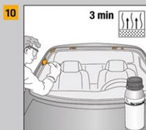
10 Die Haftfläche mit Sika® Primer-207 primern. Mindestens 3 Minuten ablüften lassen. Bei größeren Schäden muss das betroffene Teil in einer Karosseriewerkstatt repariert werden.
