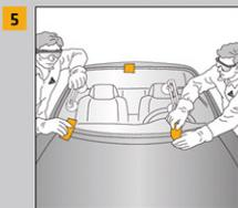
5 Einpassen der neuen Glasscheibe und korrekte Position der Scheibe mit Klebeband markieren.
