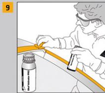
9 Karosseriefansch mit Scheibenreiniger reinigen.
