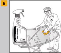
6 Die neue Scheibe mit Scheibenreiniger reinigen und auf Kontaminationen überprüfen. Falls kontaminiert, mit Sika® PowerClean Aid die Klebefläche reinigen. Mit Papiertuch die Scheibe trocken wischen.
