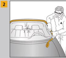
2 Schutz der Karosseriefächen mit Abdeckband zur Vermeidung von Lackschäden.
