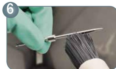
Bei der Reinigung der Düsensatz-Einzelteile ist darauf zu achten, dass die Metallteile der Bürsten den Düsensatz nicht beschädigen. Idealerweise werden Pinsel, speziell hergestellte SATA-Reinigungsbürsten und SATA-Düsenreinigungsnadeln eingesetzt, um eine optimale Pflege und Reinigung des Düsensatzes sicherzustellen.
