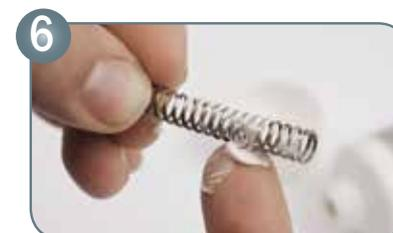
Farbnadelfeder einfetten und einsetzen
