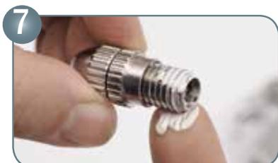
Gewinde der Materialmengenregulierschraube einfetten
