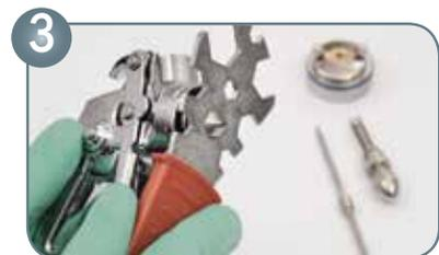
Zum Schluß wird mit dem im Universal-Werkzeug integrierten Ringschlüssel die Farbdüse ausgeschraubt.
