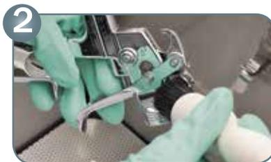
Reinigen des Pistolenkörpers
