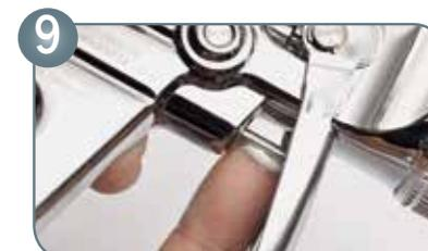
Sichtbarer Bereich der Luftkolbenstange einfetten
