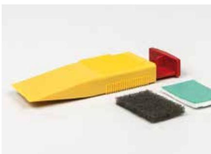
Die clevere Lösung zur Verarbeitung von Füllstoffen. Weichwachs ist mühelos einzubringen und plan beizuarbeiten. Überstände von Hartwachs und Hartwachs PLUS lassen sich mit den Rillen einfach plan „abhobeln“ - ohne die umliegende Fläche zu zerkratzen. Letzte Füllstoffrückstände werden mit dem integrierten Vlies entfernt.
